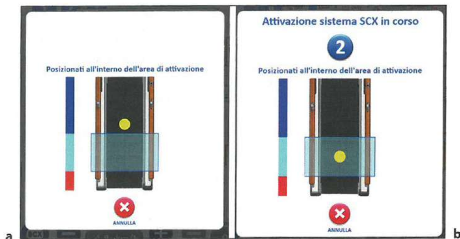
Figura 5 Primo avviso con richiesta di posizionamento (a); secondo avviso con conteggio dei tre secondi e successiva attivazione dell'SCX (b).
